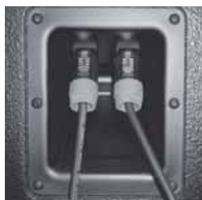
SPEAKON-Anschlüsse an der Rückseite des PowerCoax
